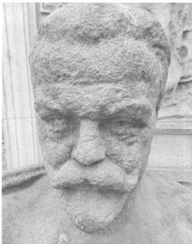
degradace povrchu kamene – původně takřka hladký
